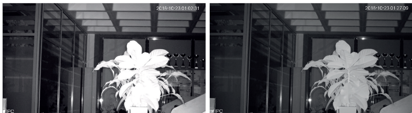
Рис. 4.17. Слева - обычная работа ИК-подсветки, справа - с функцией Smart IR
